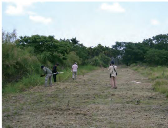
圖2：工業技術研究院利用電磁法進行遺址地下堆積分布狀況之非破壞性分析(楊淑玲拍攝)
